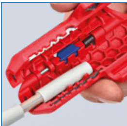
Pelar un cable NYM
