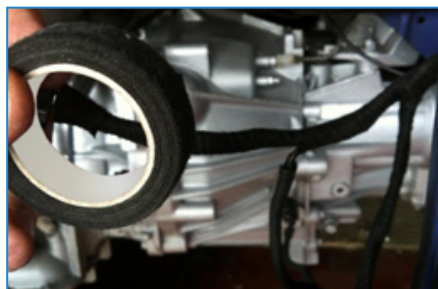
Menor efecto acústico, el rayón de la cinta amortigua las vibraciones y elimina así incómodos sonidos del vehículo.
