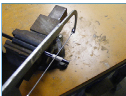
Corte bidireccional, fino, preciso y progresivo.
