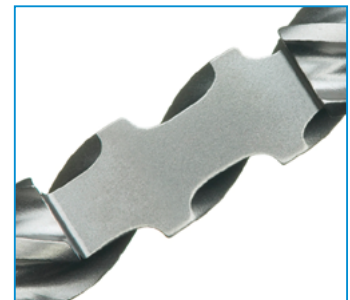
El alma de la broca está reforzada para minimizar las vibraciones y aumentar la resistencia a la rotura.
